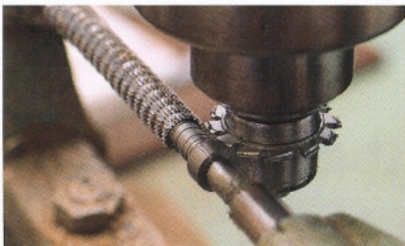
Die Produktion von stählernen Zahnrädern – Trieben – erfolgt, indem man einen Rundstahl verzahnt und anschließend die Zahnkränze einzeln abschneidet.
