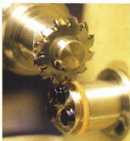
Hier wird ein Zahnrad gefräst.
