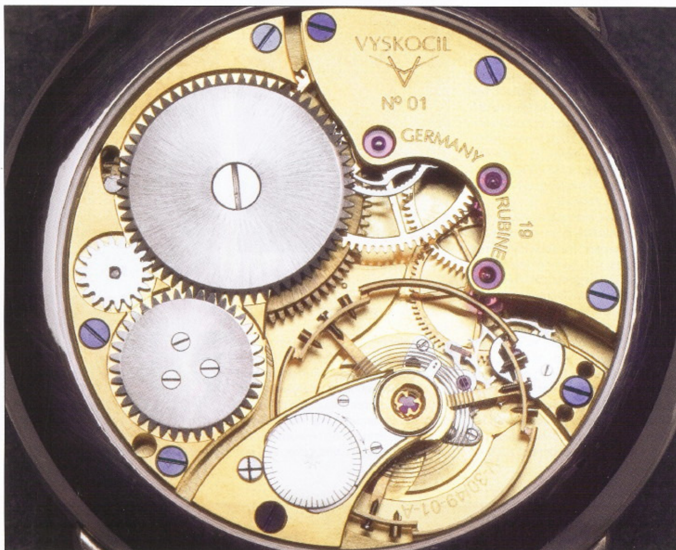
Das Kaliber «V-30/45-01-A» hat einen Durchmesser von 30 mm, ist 4,5 mm hoch und hat eine besonders große Unruh (Durchmesser 13,85 mm), die mit 19.800 Halbschwingungen pro Stunde arbeitet (2 3/4 Hz).
