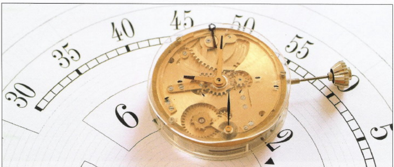
Funktionsstudie des Mechanismus' einer dreifach retrograden Anzeige.
