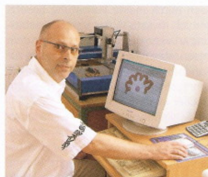
Rainer Nienaber betrachtet hier keinen «Blümchen-Bildschirmschoner», sondern die übergroße Computer-Darstellung eines Schalttriebes mit abgerundeten Zähnen. Im Hintergrund eine auf dem Prinzip eines Plotters aufgebaute Fräse.
