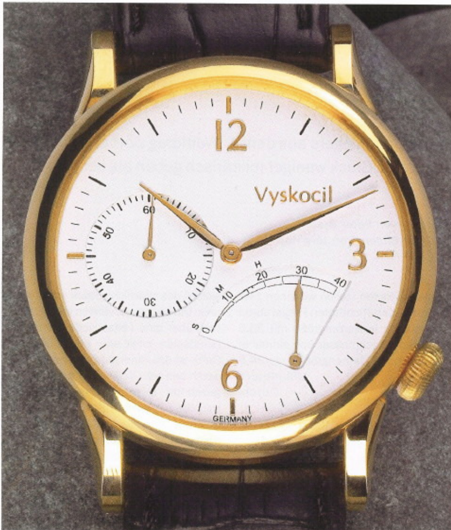
Die Buchstaben «S», «M» und «H» in der Gangreserveanzeige signalisieren die Stellmöglichkeiten «Sekunde», «Minute» und «Stunde» (Hour) bei gezogener Krone. Auch das Zifferblatt und die Stundenziffern entstehen in der niederrheinischen Werkstatt.
