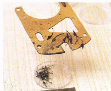
Die ETA-Uhrwerke werden bei Dornblüth auch mit einem rückführenden Gesperr ausgestattet. Hier die dafür gefertigten Sperrfedern, die auf einer alten Großuhrplatine mit einem Heißluftgerät gebläut werden.
